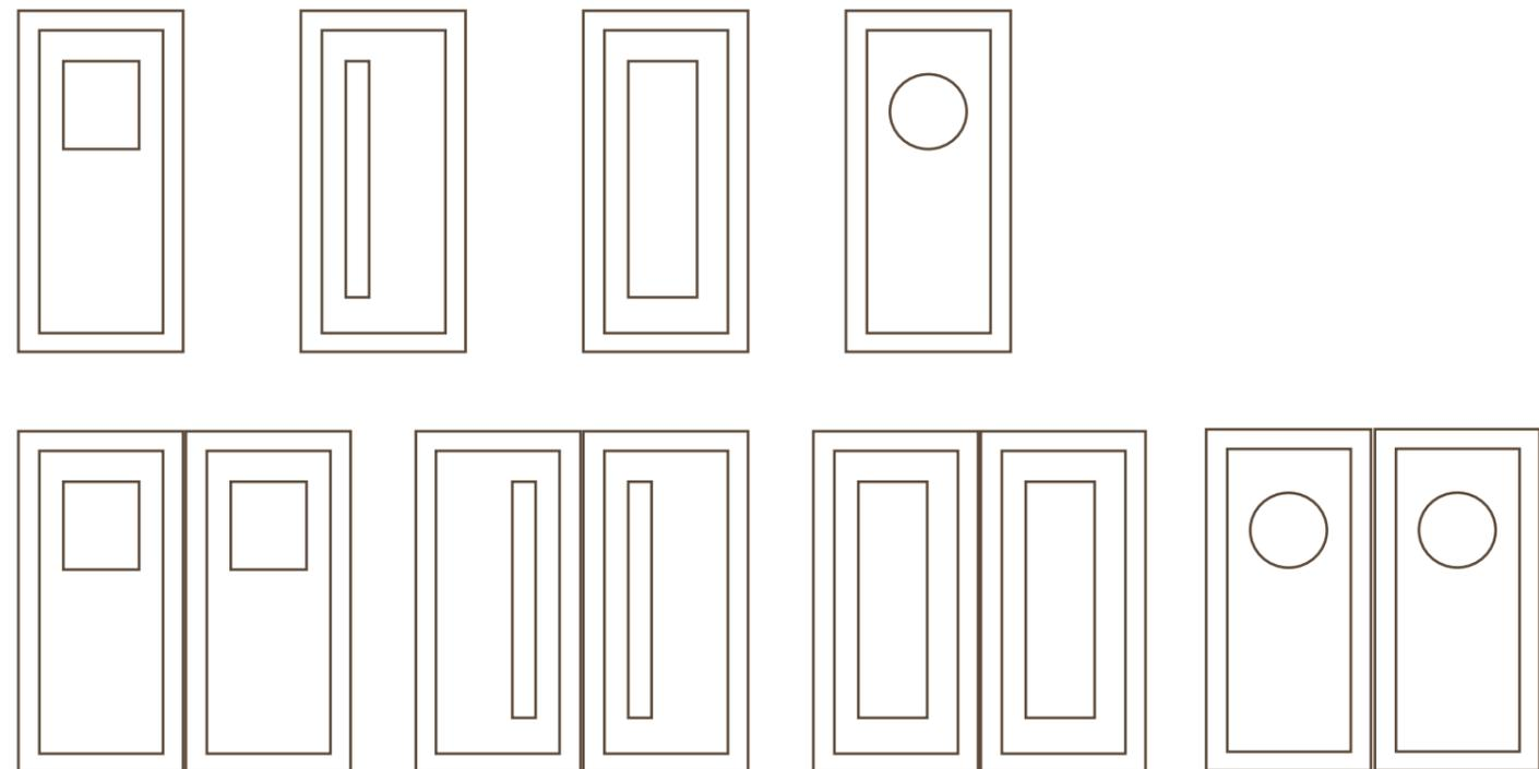
Для производства таких противопожарных дверей применяется многослойное огнеупорное стекло, обладающее теми же пределами огнестойкости, как и вся конструкция; преимущество остекленных противопожарных дверей — возможность осмотреть помещение, оценить степень задымленности и ареал распространения огня).
